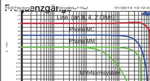
Ausgewogen und breitbandig, sehr laststabil, bei MM-Phono etwas Höhenabfall.
