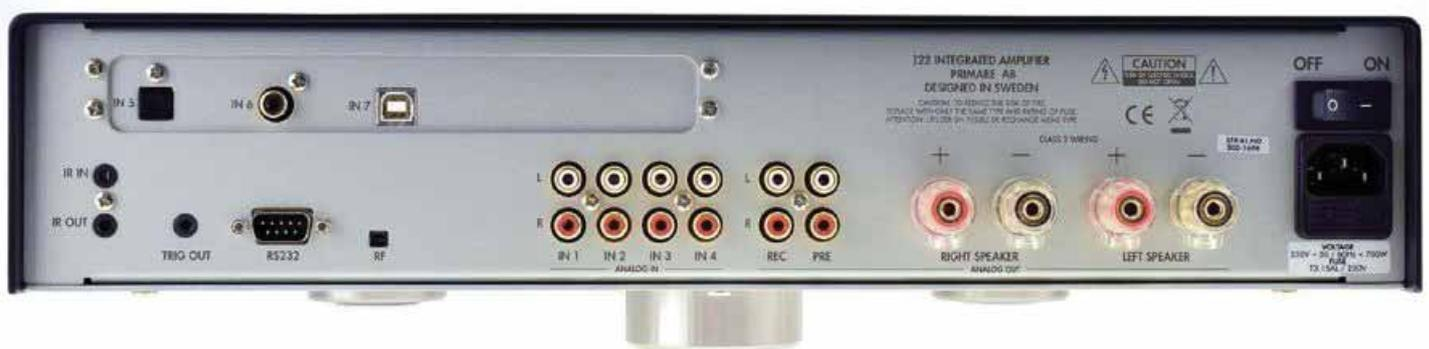
Der typische Vollverstärker: Primare offeriert mit dem I22 einen sehr kräftig ausgelegten Verstärker mit optionaler D/A-Wandlertarte im Vollformat-Gehäuse. Seine Pre- und Rec-Anschlüsse dürften heutzutage schon fast als Seltenheit gelten.
