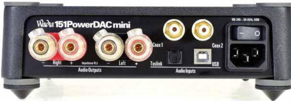
Der an sich typische Power-DAC: Wadias PowerDAC mini bietet ausschließlich digitale Eingänge an und ist mit zwei koaxialen Eingängen zusätzlich zum USB-Anschluss ausgestattet.
